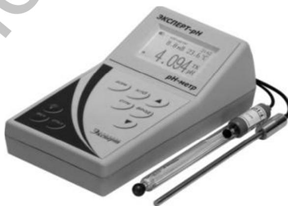
Рис. 54. рН-метр Эксперт
