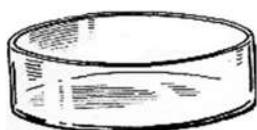
Рис. 9. Кристаллизатор
