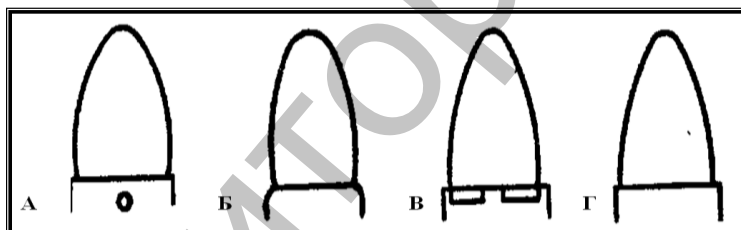
Рисунок 2.41 – Крепление пули к гильзе: А – кернение; Б – обжим кромки дульца; В – сегментный отжим; Г – безнажимное крепление.
