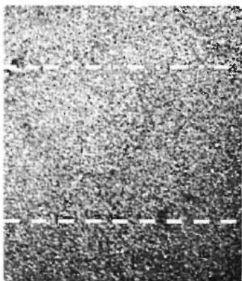
Рис. 3. Сплошная структура слитка (центральный участок, обозначенный линиями, приблизительно соответствует расположению исходных частиц; шлиф в плоскости, перпендикулярной слою частиц; без травления)
