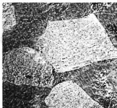
Рис. 4. Различия в структуре различных компонентов слитка, выявленные в результате травления (шлиф в плоскости слоя частиц, светлые участки – исходные частицы алюминия, темные участки – закристаллизованный расплав алюминиевого сплава)
