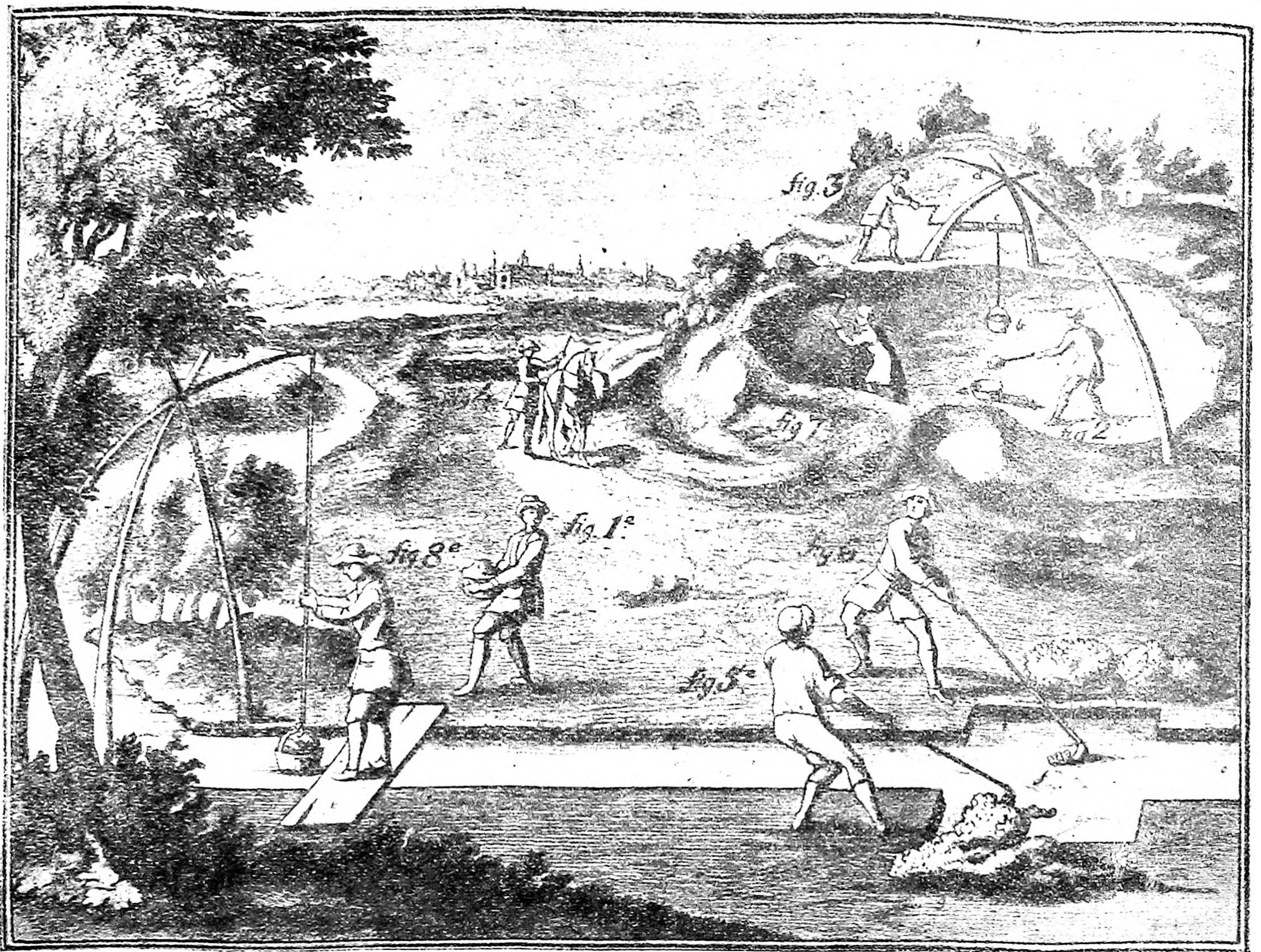
Рис. 1. Добыча и промывка дерновых руд.
