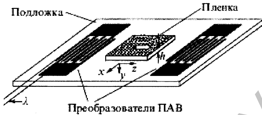
Рис. 1. Принципиальная схема высокочастотного пьезоприемника.
