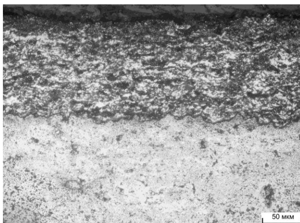
Рис. 1. Микроструктура композиционного покрытия \text{Al}_2\text{O}_3/\text{Cu} ( \times 200 ).
