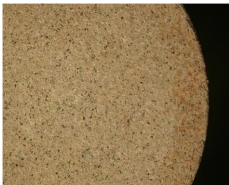
Рис. 2. Структура керамики на основе оксида алюминия, полученная обжигом в СВЧ поле в течение 20 мин.
