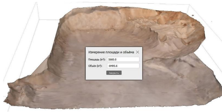
Рисунок 2 – Расчет площади и объема выемок в Agisoft Metashape
