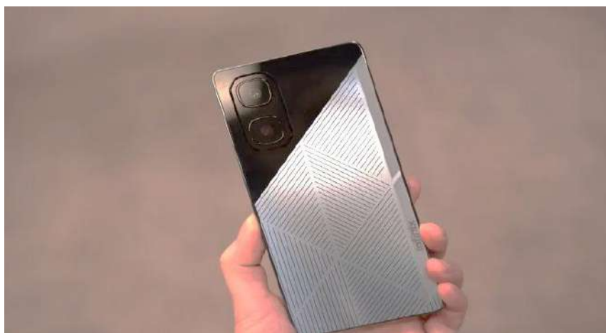
Рисунок 1 - Смартфон Infinix с солнечной панелью [4]
