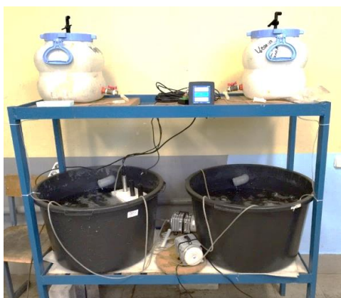
Рис. 1. Лабораторная модель системы биологической фильтрации
