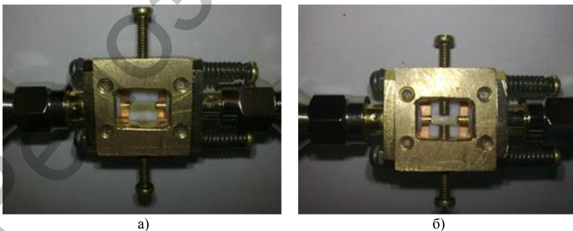
Рисунок 1 – Вид испытательного контейнера а) при измерении КСВ б) при измерении АЧХ
