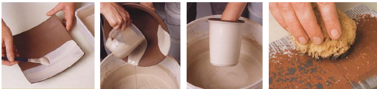
Рисунок 35. Способы нанесения ангоба
