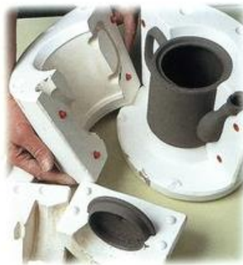
Рисунок 28. Этапы шликерного литья в гипсовой форме
