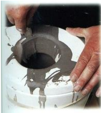
Рисунок 28. Этапы шликерного литья в гипсовой форме
