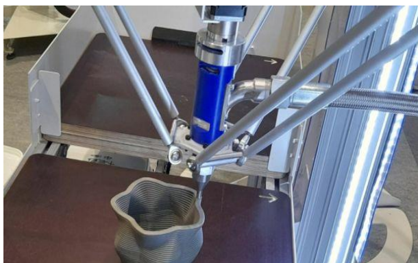
Рисунок 19. Экструзионная печать, 3D-принтер
