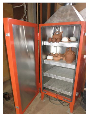
Рисунок 6. Электрический сушильный шкаф
