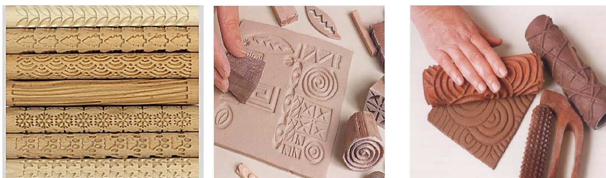
Рисунок 22. Штампы, рельефные скалки и валики
