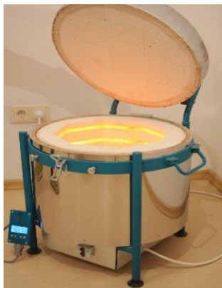
Рисунок 2. Печь шахтного типа
