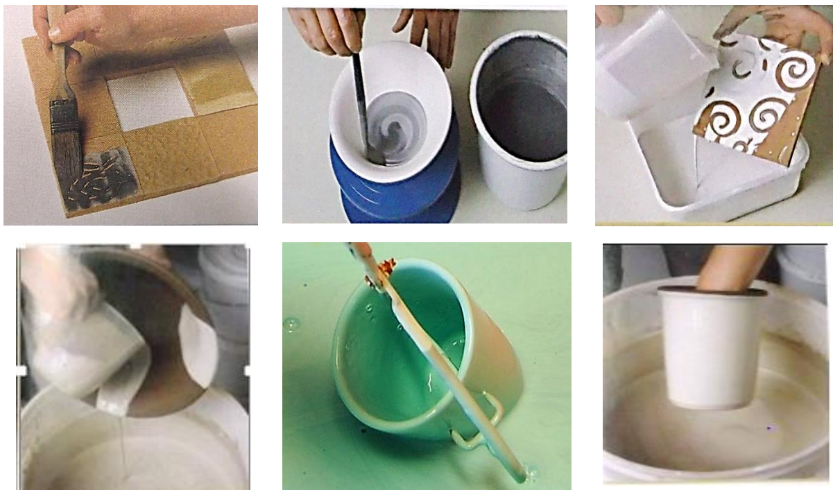
Рисунок 47. Способ нанесения глазури кистью, поливом, окаткой и окутанием.
