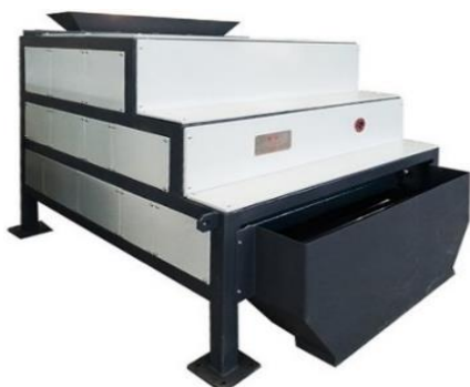
Рисунок 15. Магнитный сепаратор (ловушка)
