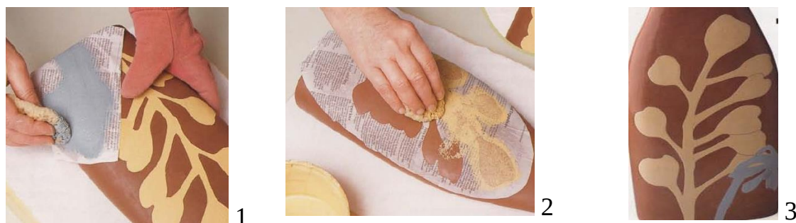
Рисунок 40. Трафаретная печать (печать рисунка)
