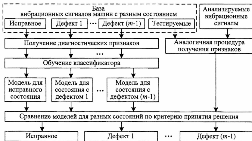
Рисунок 1 – Обобщенная структурная схема автоматизированного обнаружения дефектов вращающихся механических узлов
