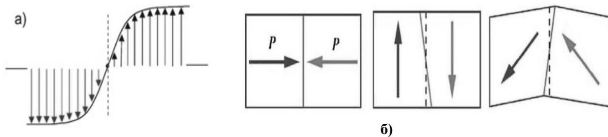
Рисунок 1 – Доменные границы различного типа в одноосных сегнетоэлектриках:
