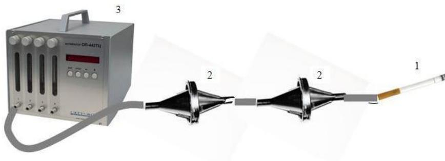
1 – сигарета; 2 – последовательно подключенные аллонжи с закрепленными в них фильтрами АФА-ВП; 3 – электроасpirатор.
