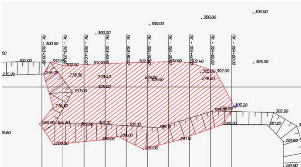
Рис. 12. Расчет объема по сечениям. Сечения отображены на плане
