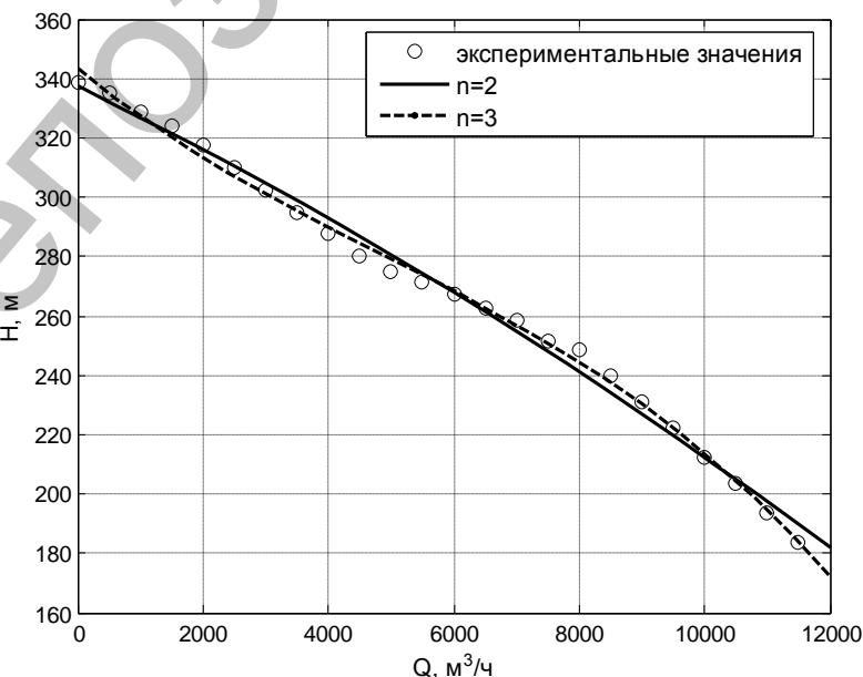
Рис. Аппроксимация напорной характеристики насоса НМ 10000–210.
