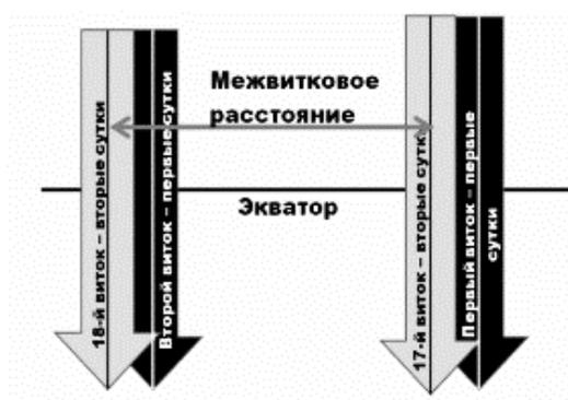
Рисунок 15 – Смещение полос съемки со спутника
