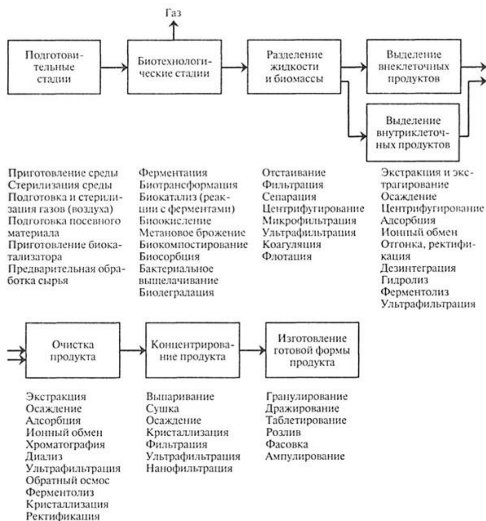
Рисунок 1. – Типовая схема, основные стадии и реализующие их технологические процессы в биотехнологических производствах
