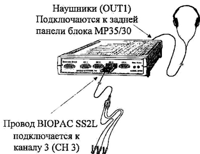
Рисунок – Основной блок Biopac Student Lab. MP35
