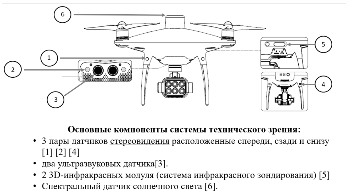
Рисунок 7 – Датчики ориентирования и обнаружения препятствий БЛА DJI Phantom
