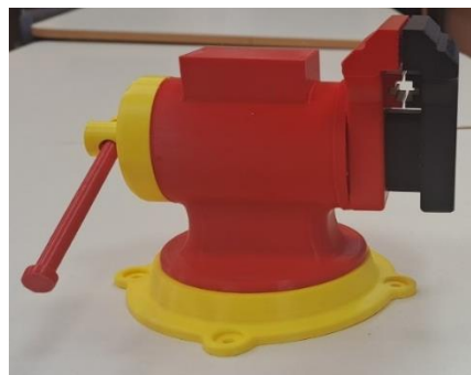
Рисунок 4 – Спроектированные в программе Компас 3D слесарные тиски и напечатанные на 3D-принтере
