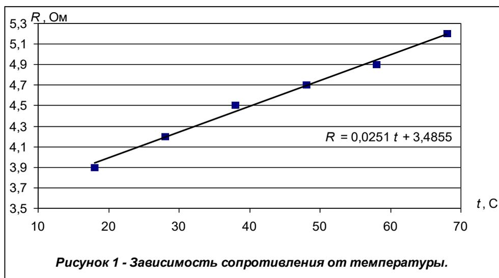
Жирными маркерами на рисунке обозначены точки, соответствующие экспериментальным результатам. Теоретически известно, что данная зависимость должна иметь линейный вид, что и наблюдается по графику.
