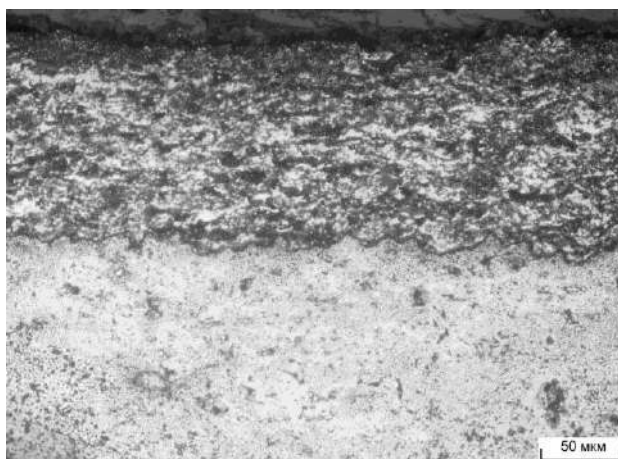
Рис. 1. Микроструктура композиционного покрытия \text{Al}_2\text{O}_3/\text{Cu} ( \times 200 ).
