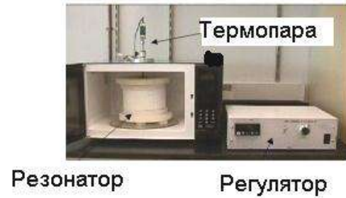
Рис. 1. Общий вид СВЧ резонатора с блоками регулировки мощности и измерения температуры.
