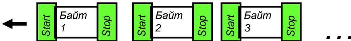
Рисунок 7.1 – Асинхронный протокол
