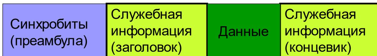
Рисунок 7.2 – Общий формат кадра синхронных протоколов
