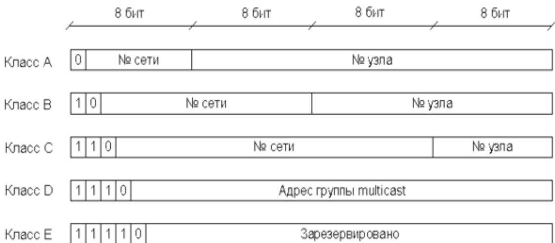
Рисунок 5.2 – Деление адресов IPv4 на классы
