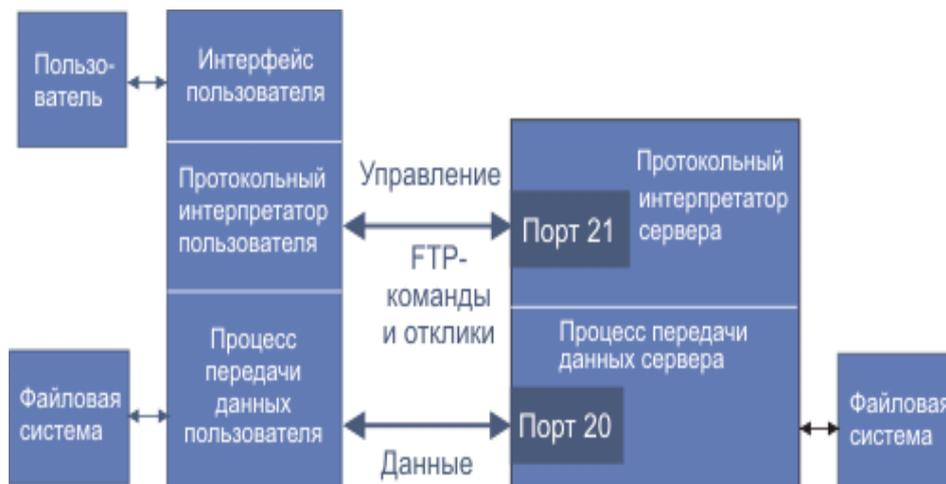
Рисунок 3.1 – Обмен данными в протоколе FTP
