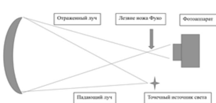
Рисунок 2 – Схема. Экспериментальная установка
