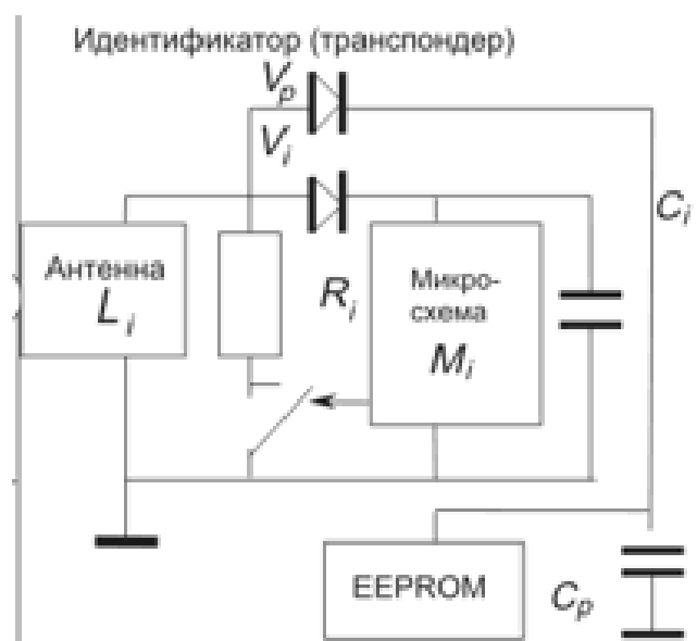
Рисунок 1 – Принцип работы RFID метки
