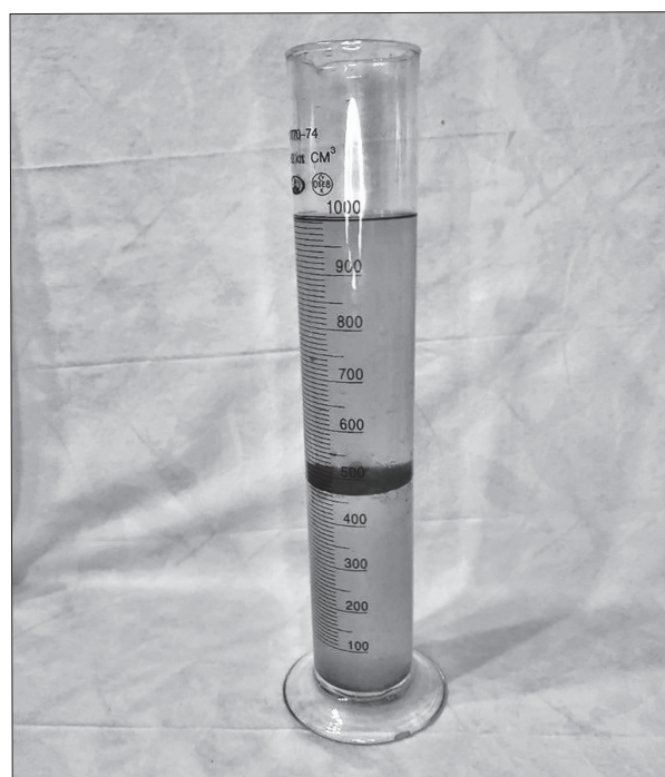
Рис. 5. Дифференциация материала нефтяной линзы (300 минут с начала эксперимента) [Fig. 5. Differentiation of the oil lens material (300 minutes from the beginning of the experiment)]
