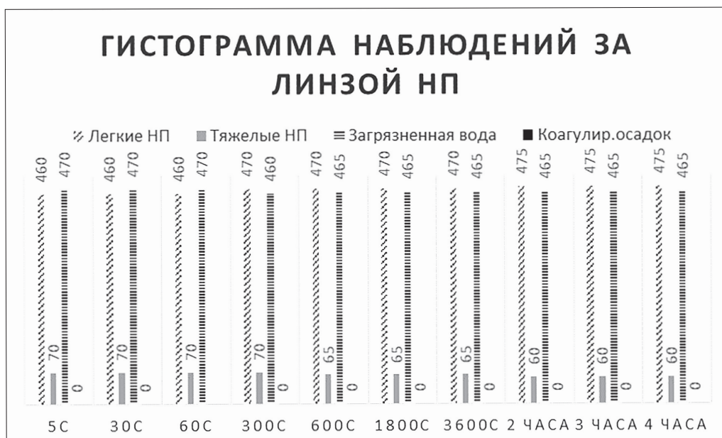
Рис. 7. Динамика дифференциации материала линзы с начала эксперимента до 4 часов эксперимента [Fig. 7. Dynamics of lens material differentiation from the beginning of the experiment to 4 hours of the experiment]
