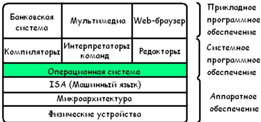
Рисунок 1 – Место операционной системы в структуре ПО компьютера
