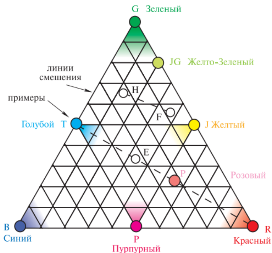
Рис. 2 – Треугольник Д.К. Максвелла – график смешения цветов на основе трехкомпонентной теории цветового зрения Г. Гельмгольца. Аддитивным смешением монохроматического света определенных длин волн, соответствующих красному, зеленому и синему можно получить широкий диапазон цветов разной насыщенности
