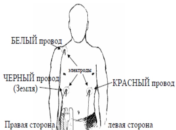
Рисунок 2 – Размещение электродов и электродных проводов.
