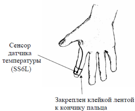
Рисунок 3 – Размещение и закрепление сенсорного датчика температуры
