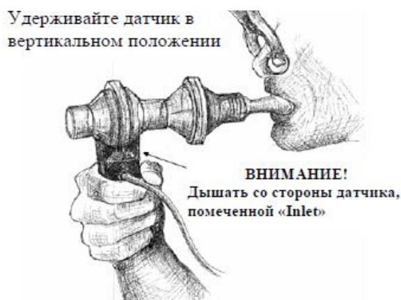
Рисунок 5 – Схема положения датчика для процедуры калибровки
