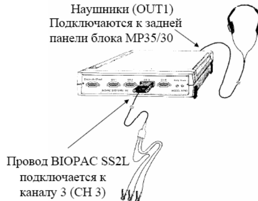
Рисунок 9 – Схема подготовки прибора к работе
