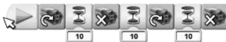
Рисунок 5 – Схема алгоритма робота для управления мотором
