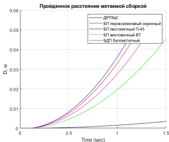
Рисунок 3 – Зависимость пройденного расстояния метаемой сборки от времени
