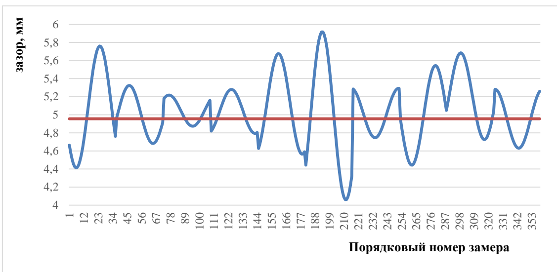
Рисунок 5 – Зазор для детали диаметром 29,73 мм
