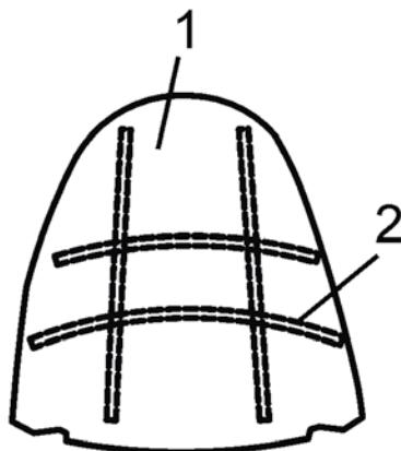
Рисунок 1 – Деталь носка заготовки верха обуви
