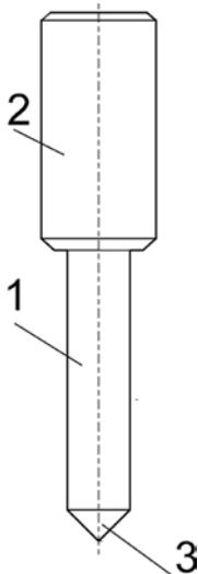
Рисунок 3 – Инструмент для выполнения разметки пластин кассеты
