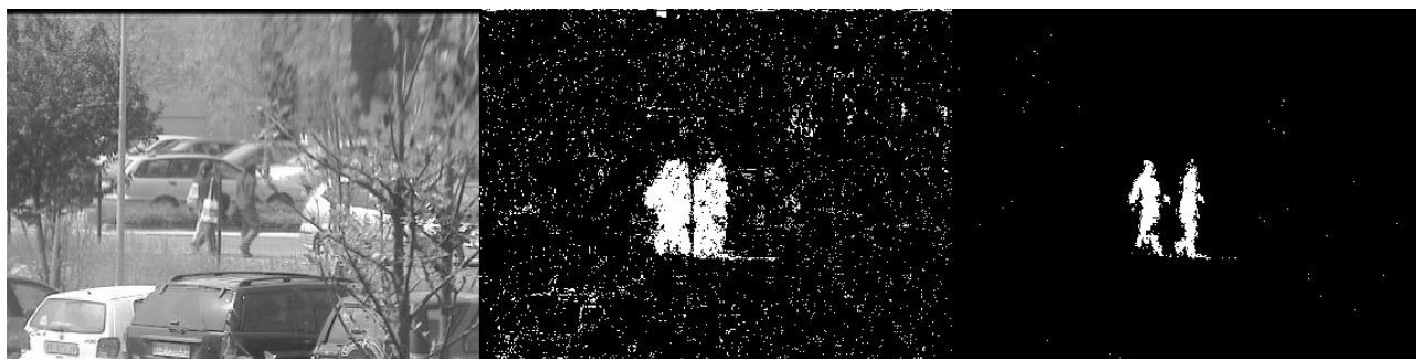
Рисунок 2 – Исходное изображение, результат сегментации движения базовым методом, результат сегментации движения модифицированным методом сегментации (без использования фильтрации и операций морфологии)
