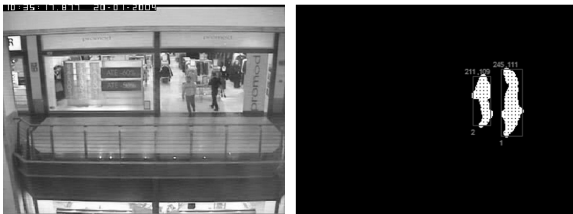
Рисунок 3 – Исходное изображение и отсегментированное бинарное изображение с выделением объектов, определением координат их центров и описанных прямоугольников.
