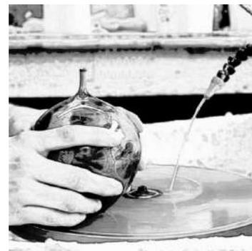
Рисунок 4. Шлифовка алмазным диском
