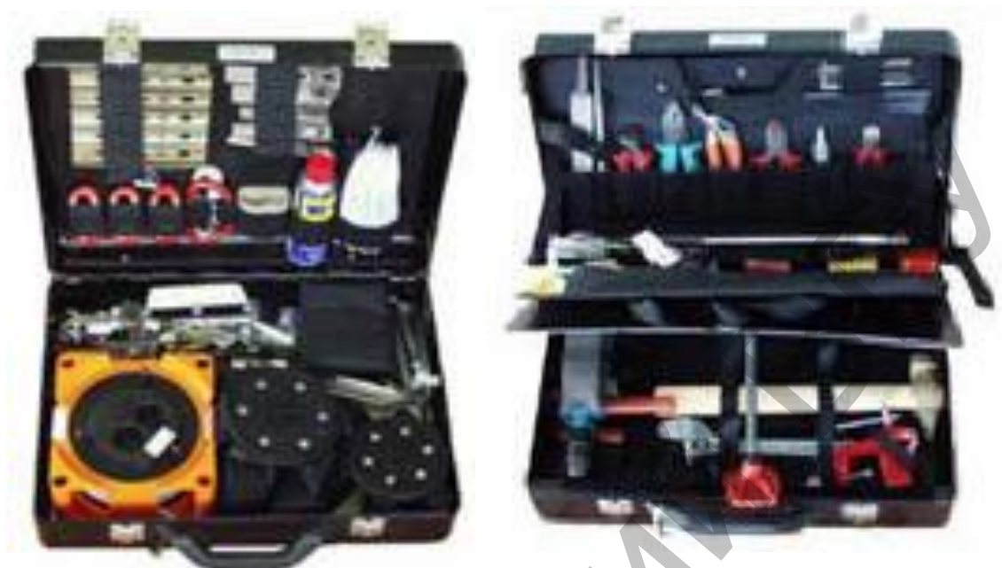
Рисунок 11 – Комплект эксперта-взрывотехника "Кратер" (фиксаторы, тросы и лебедка для страгивания с места, опрокидывания и перемещения объектов, приспособление для провешивания тросов, слесарный инструмент, средства защиты органов зрения).
