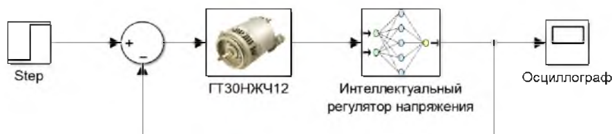
Рисунок 2 – Виртуальная система с генератором ГТ30НЖЧ12 и интеллектуальным регулятором напряжения
