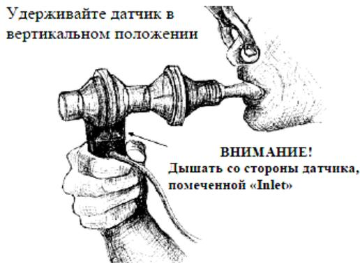
Рис. 5. Схема положения датчика для процедуры калибровки.
