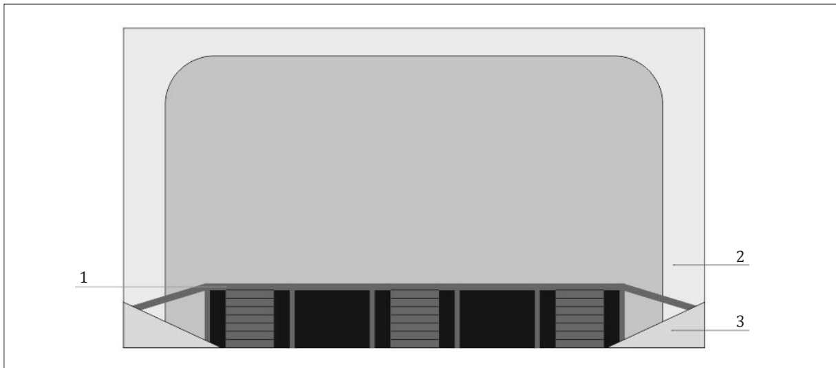
Рис. 8. Зеркало сцены при открытой арьерсцене. Доминирующие геометрические формы в кубе сцены. 1 – помост; 2 – арка арьерсцены; 3 – малая архитектурная форма.
