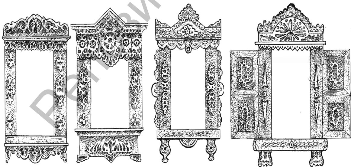
Рис. 69. Эскизы наличников. Плоскопрорезная резьба.
