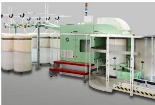
Рисунок 6. Ленточная машина-DF1 - DFR1
