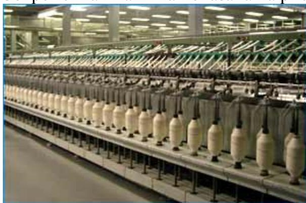
Рисунок 13. Пневмомеханическая машина прядения.
