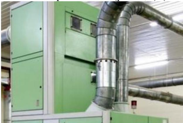
Рисунок 4. Разрыхлитель с двумя трепалами-В390L
