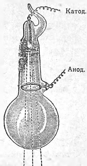
Рис. 17. Направление катодных и рентгеновских лучей.
