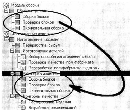
Рис. 6.3. Вид моделей в Model Explorer после слияния. Выделены: модель–источник и присоединенная ветвь модели–цели
