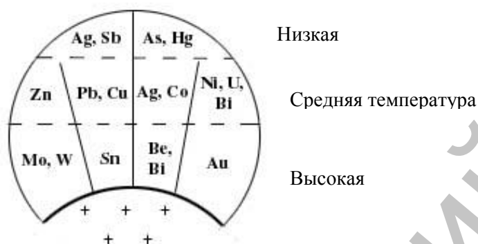
Рис. 15. Схема минерализации жил по мере их удаления от источника гидротермальных растворов и снижения их температуры (И.Т. Бакуменко и др., 2001 г.)
