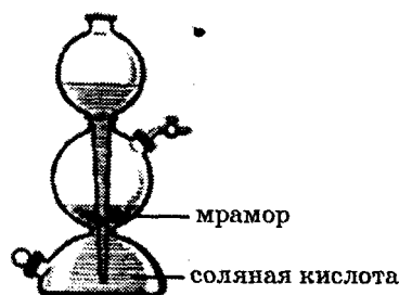
Рисунок 5 — Получение углекислого газа в аппарате Киппа
