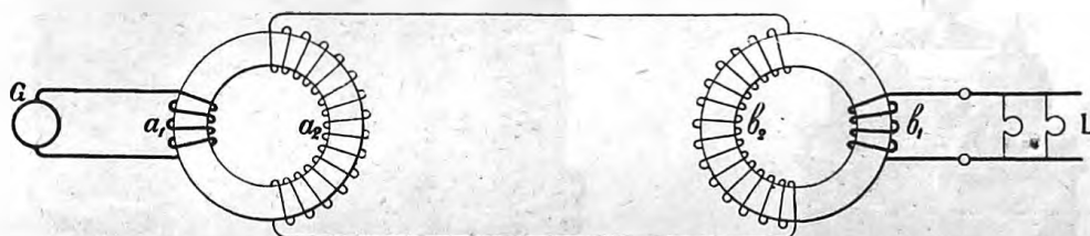
Рис. 424. Схема передачи энергии с трансформаторами.
