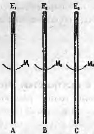
Рис. 478. Передача колебаний от одного вибратора к другому.
