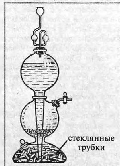
Рис. 1. Аппарат Киппа для получения газов
