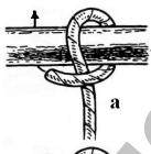
Может применятся для вязки носилок. Узел вяжется вокруг веревки или вокруг опоры.
