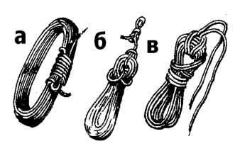
Марка (a) - вспомогательный узел. Применяется для скрепления веревки, уложенной в бухту, так называемая маркировка в классической манере.
