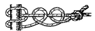
Рабочий конец обносится вокруг дерева (колец, проушин, крюков и т. п.) и загибается вокруг ходовой веревки, затем обносится обратно вокруг дерева, налаживается на ходовую веревку, продевается
