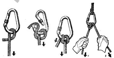
• Еще раз простегивается через карабин. Согласно этому рисунку веревка будет выдаваться снизу вверх. При перемене направления движения веревки, узел перевернется на карабине, сохранив рисунок, и будет работать в другую сторону.
